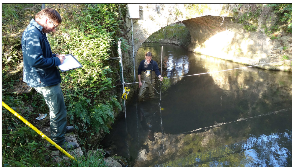
Le Petit-Morin à Montmirail (95) (photo prise le 02/10/2014) Jaugeage au moulinet
