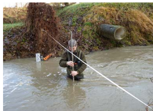
Jaugeage au moulinet sur le Lieutel à Neauphle-le-Vieux(78)
