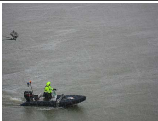
Jaugeage au doppler sur la Seine à Vernon (27)
