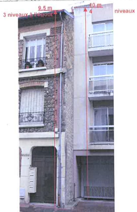
Hauteur des rez-de-chaussée : environ 2,50m pour un bâtiment récent et 4m. pour un bâtiment ancien : ce dernier compte 3 niveaux alors que le récent en compte 4 pour une hauteur identique
