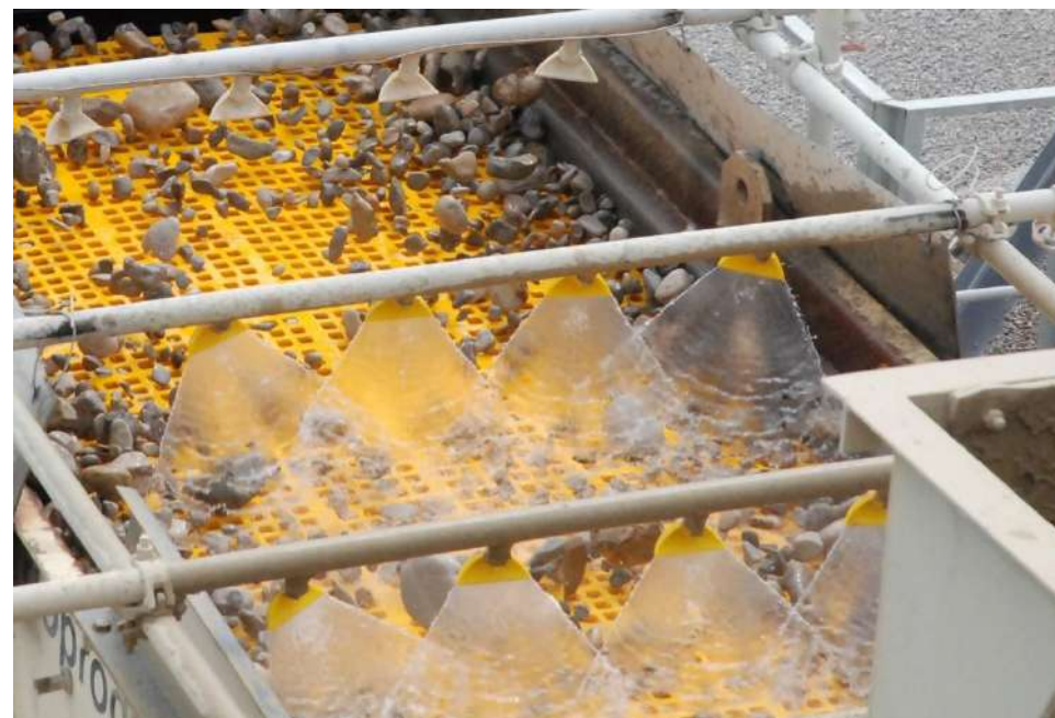
Figure 14 : Le traitement des granulats pour permettre d'obtenir des granulats répondant à des spécifications bien précises (photo : E. Fromentin – UNICEM).
