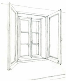
La technique de la double fenêtre est courante dans les régions froides, notamment en montagne
