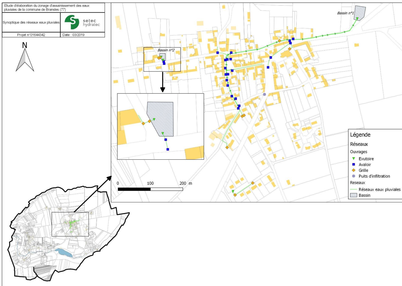
Figure 2.13 : Synoptique du réseau eaux pluviales
