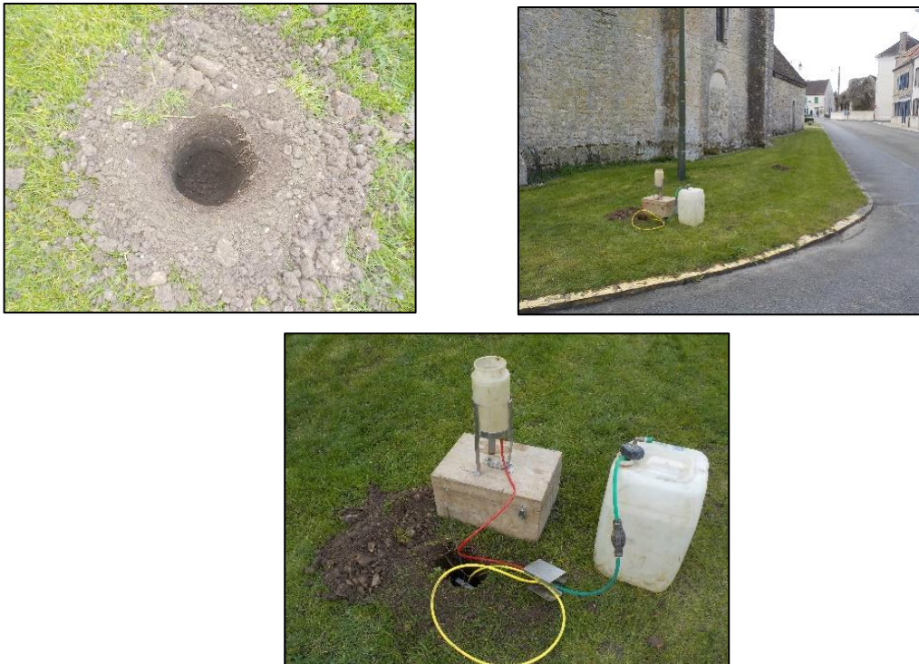
Figure 4.1 : Aperçus d'un essai type Porchet
