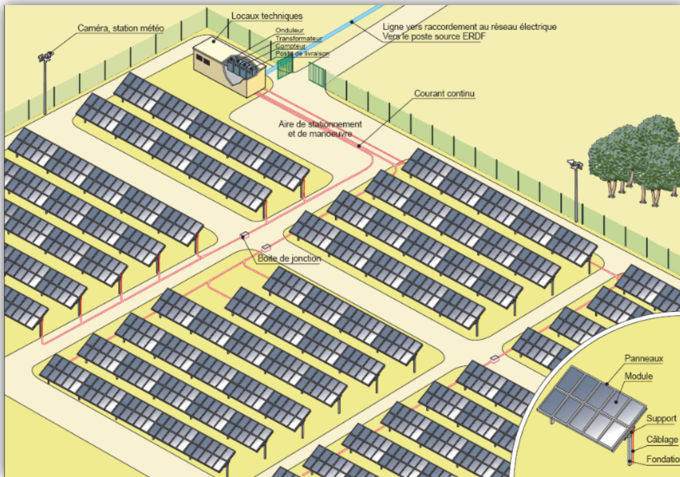
Principe d'implantation d'une centrale solaire
