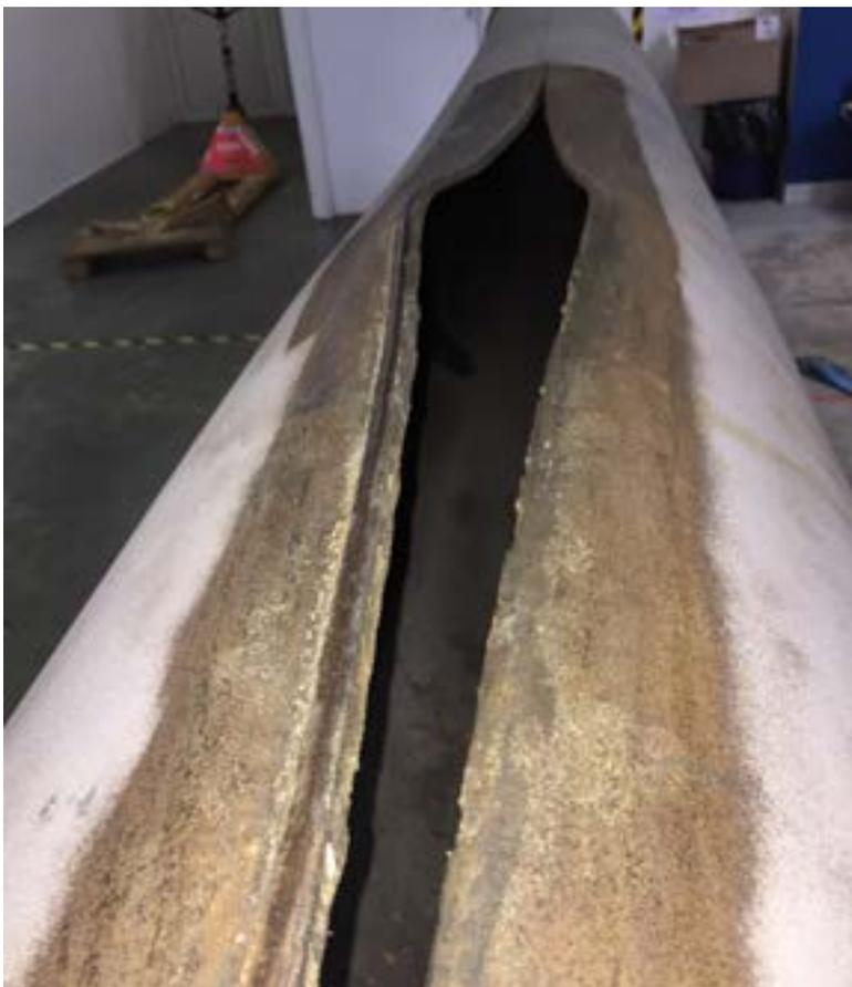
Corrosion fissurante de la canalisation du PLIF 2019, Source DRIEE
