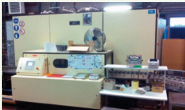
En faisant l'acquisition en 2009 d'une installation de dégraissage au perchloréthylène, en remplacement d'un équipement fonctionnant au trichloréthylène, l'entreprise Vernet à Ollainville (91) a choisi une technologie innovante afin de réduire significativement ses émissions de COV.
