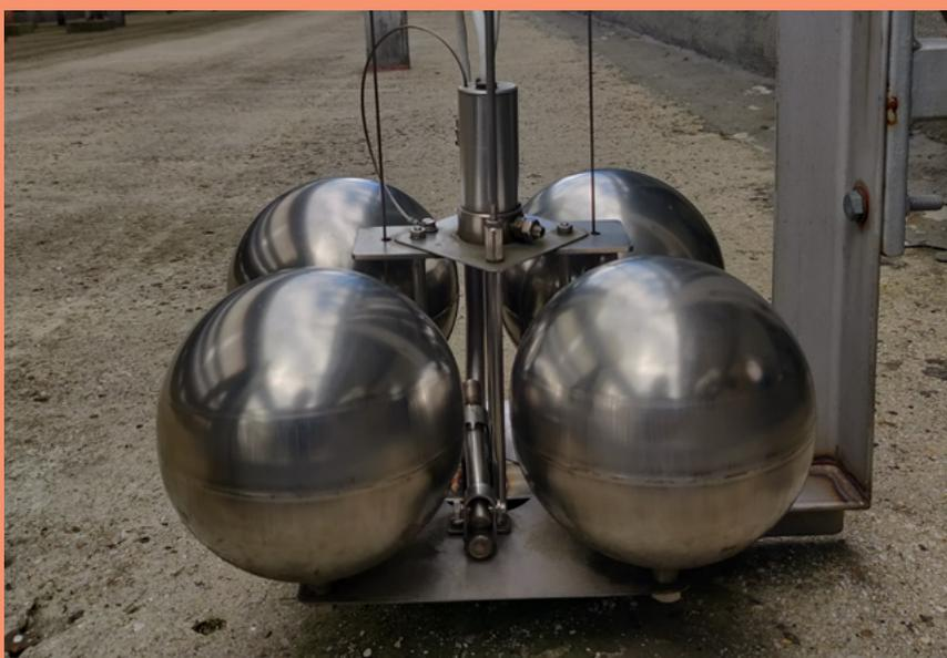
Exemple de MMR : détecteur d'hydrocarbures liquides (sonde Jola® à électrodes flottantes)
